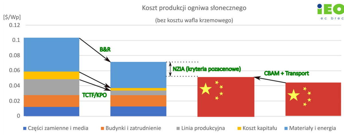
Rysunek 7.2. Wpływ programów unijnych na konkurencyjność europejskiego przemysłu na przykładzie kosztów produkcji krzemowego ogniva PV. Dopiero kombinacja wszystkich form wsparcia dostępnych dla krajów UE może pozwolić na powrót produkcji urządzeń fotowoltaicznych do Europy
